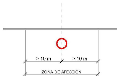
Fig.: Afección de gasoductos y oleoductos (esquema orientativo)
